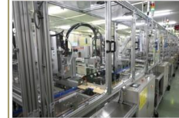
枚方工場で構築する複合機部品のスマートラインが試験的に稼働する様子。写真中央が最新機LSU（同社提供）
